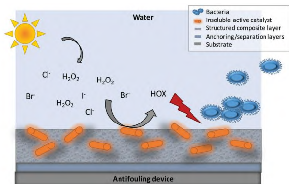
图 1 含有类卤代过氧化物酶活性的防污装置中活性物质的工作机理 [29]
